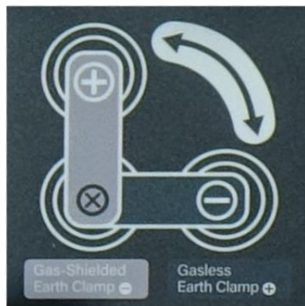
Rys. 2b. Pomocnicza grafika opisująca gniazda polaryzacji, gdzie: Gas shielded earth clamp (-) oznacza wpięcie przewodu masowego do gniazda (-), przy spawaniu z gazem Gasless earth clamp (+) oznacza wpięcie przewodu masowego do gniazda (+), przy spawaniu bez gazu (FLUX)
