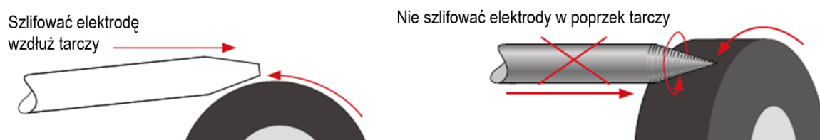
Rys. 14. Szlifowanie elektrody wolframowej
