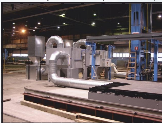
Odciąg zanieczyszczeń z segmentowego stołu do cięć
